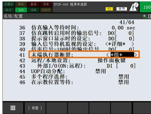
图 6- 2 找到“末端执行器断裂”选项
