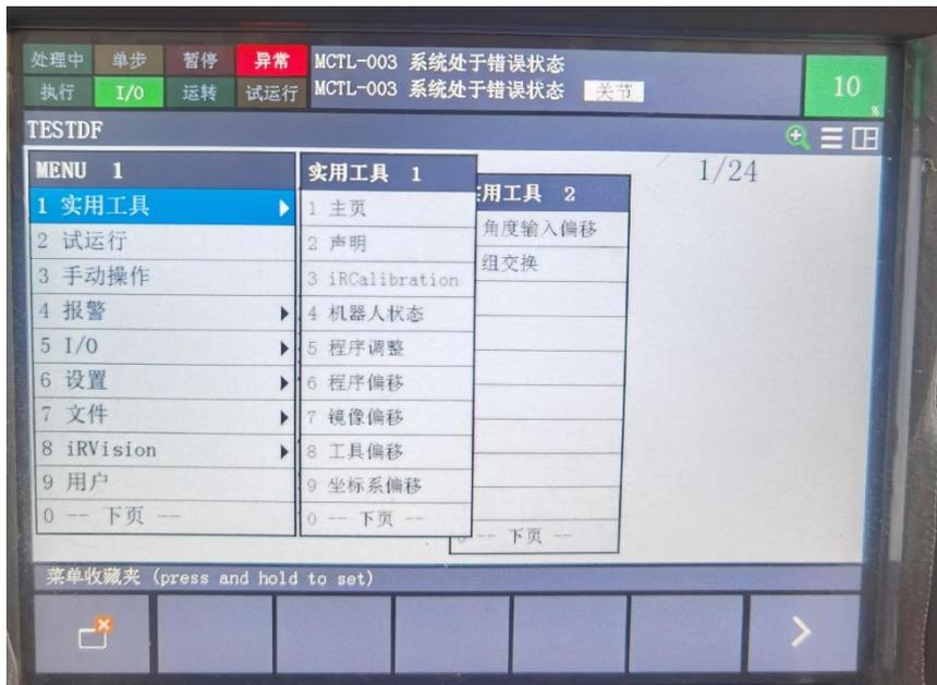
**原因分析：**操作顺序有问题，出现报警后直接按【RESET】复位报警不起作用。
